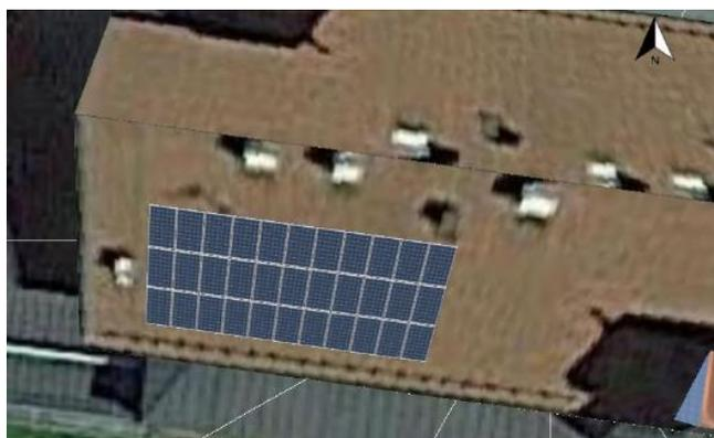
Abbildung 5-14: PV-Anlage auf dem Süddach des Rathauses.
