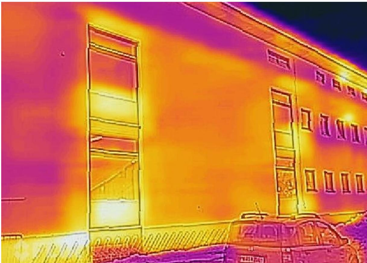
Abbildung 5-7: Wärmebild der Außenfassade der Mittelschule.
