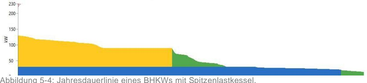
Abbildung 5-4: Jahresdauerlinie eines BHKWs mit Spitzenlastkessel.
