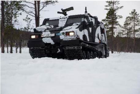
In seinem Element: Das BV206S ist das Standardfahrzeug der Gebirgsjäger und für tiefen Schnee gebaut. Foto: Gebirgsjägerbataillon 233.
