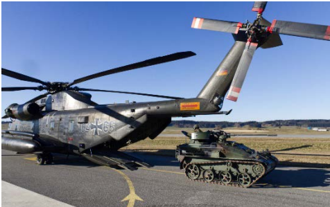
Der CH-53 kann den Waffenträger Wiesel als Innen- oder Außenlast transportieren. Foto: Gebirgsjägerbrigade 23.
