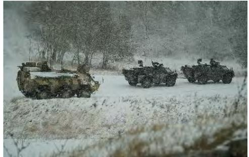
Nach simuliertem Fahrzeugausfall wird ein Spähwagen Fennek durch einen anderen Spähwagen geborgen und mitgeführt.
