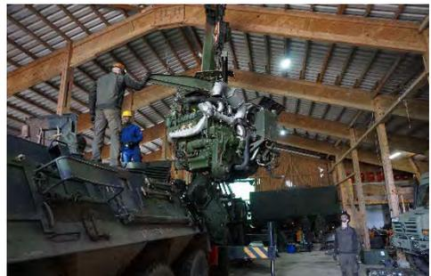
Ein Triebwerk eines TPz „Fuchs“ wird mit einem Kran aus dem Fahrzeug gehievt. Fotos: Bundeswehr / Gebirgsversorgungs-bataillon 8.
